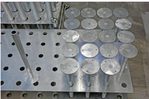
Verschiedene Stützenlängen werden so vorbereitet und danach auf der Baustelle eingesetzt.
