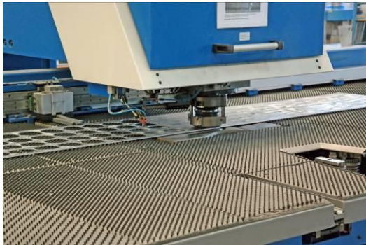
Die Rondellen werden aus dem Restblech ausgestanzt
