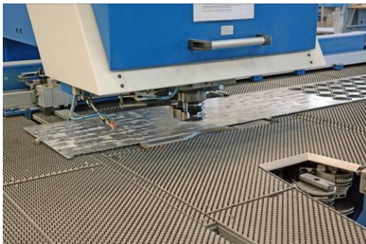
Hier werden die Rondellen aus dem Blech mit dem Werkzeug herausgestanzt
