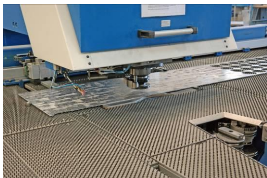
L'outil découpe les rondelles dans la tôle
