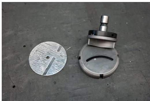
Les rondelles et l'outil de poinçonnage
