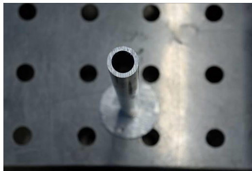
Tubo in alluminio pretranciato a una determinata lunghezza
