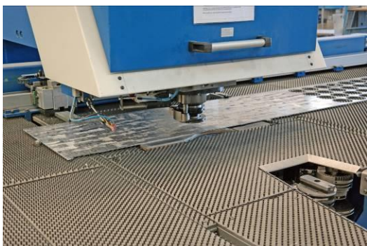
Tranciatura delle rondelle in lamiera mediante l'apposito utensile
