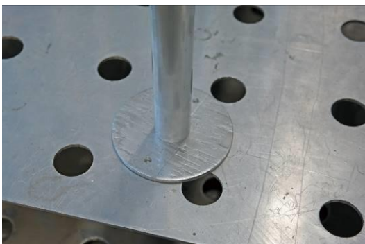
Tubo in alluminio inserito sopra il perno e incollato
